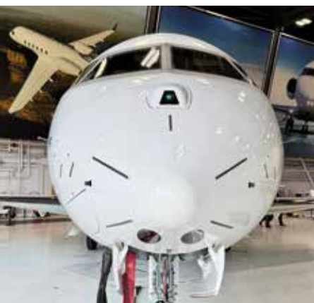
Koneen EVS-järjestelmän infrapunakamera näkyy tuulilasin alapuolella.
