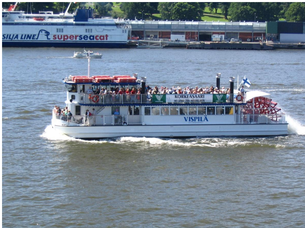
Bild På passagerarfärjor som rör sig i närheten av kusten finns i allmänhet flytanordningar. Flottarna på hjulångaren Vispilä har placerats på styrhyttens tak.
