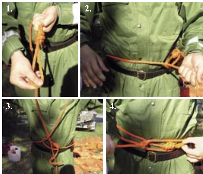
Esimerkki pintapelastajan turvaköyden solmisesta. Kuva RMVK
